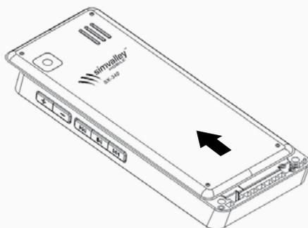
Der Akkufachdeckel lässt sich so etwa einen halben Zentimeter verschieben. Nachdem Sie den Deckel nach oben geschoben haben, können Sie ihn einfach abheben.
