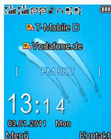
Dieser Bildschirm wird Ihnen direkt nach dem Einschalten des Handys angezeigt. Die Abbildung ist beispielhaft und zeigt Ihnen alle Symbole an, die während des Betriebs dort angezeigt werden können. Mit der LSK-Taste rufen Sie das Hauptmenü auf. Mit der RSK-Taste erreichen Sie direkt die Telefonbuch-Funktion.
