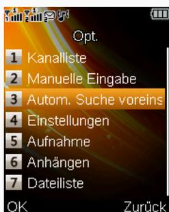
Wählen Sie im Optionsmenü den Punkt **Autom. Suche voreinstellen**, um einen automatischen Sendersuchlauf zu starten. Die gefundenen Sender werden automatisch der Kanalliste zugeordnet und können dort weiter bearbeitet werden.
