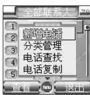
按 键确定选择新增电话，进入添加新电话界面。您可以通过上下导航键选择需编辑的项目。编辑名字或者号码时，按 键进入输入内容项目；编辑存储位置时，通过按左右导航键进行选择。
