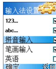
进入此项后，屏幕会显示本机所有的输入法，用上下导航键上下翻动，按 $\text{[*]}$ 键或 $\text{[#]}$ 键选择或不选该输入法。最后按 $\text{[.]}$ 键确定即可。
