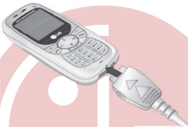
Para desconectar o carregador, pressione as travas nas laterais do conector (1) e puxe o adaptador (2).
