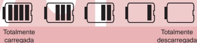
Quando o nível de carga da bateria fica baixo, o número de barras diminui e o sensor de bateria fraca alerta-o de três maneiras: alerta sonoro, piscando o contorno do ícone de bateria e exibindo **“BATERIA FRACA”**. Se o nível de carga da bateria ficar muito baixo, o telefone desligará automaticamente e qualquer função em andamento não será salva (armazenada).
