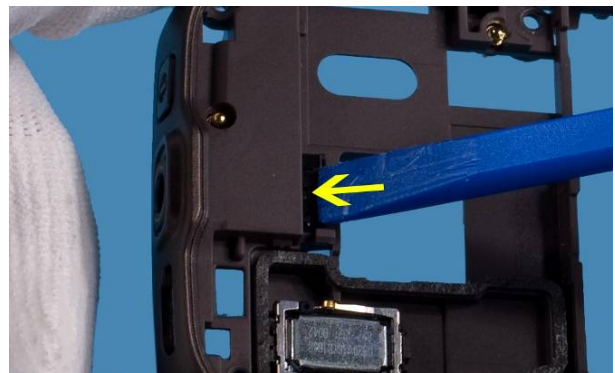
30) Press out the AV CONNECTOR .
