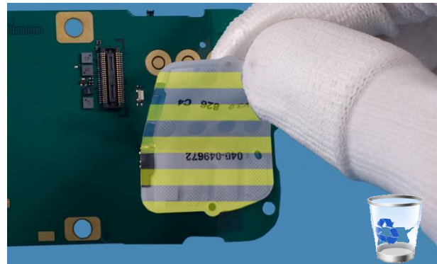
20) Remove the DOMESHEET .
