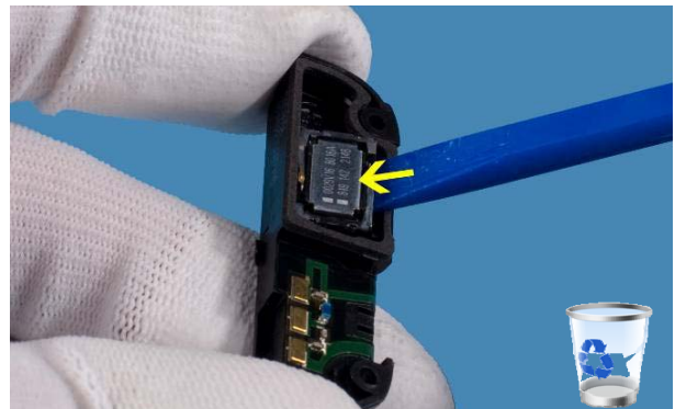
28) Use SS-93 tool to remove the IHF SPEAKER .
