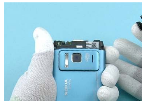
26) Remove the COMBO ANTENNA.
