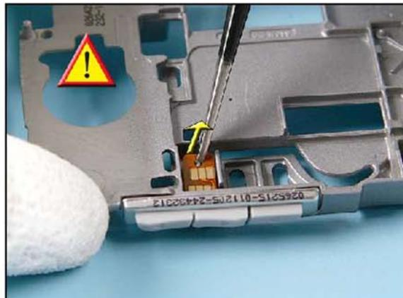
24. Unlock the SIDE BUTTON MODULE ASSY...
