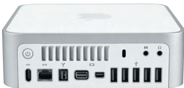
Сзади целых пять USB, два видеовыхода, порт FireWire 800
