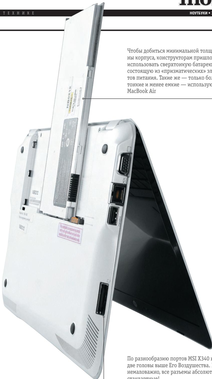
Чтобы добиться минимальной толщины корпуса, конструкторам пришлось использовать сверхтонкую батарею, состоящую из «призматических» элементов питания. Такие же — только более тонкие и менее емкие — используются в MacBook Air
