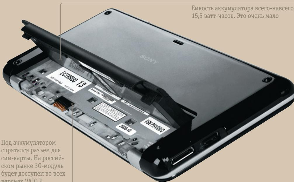
Емкость аккумулятора всего-навсего 15,5 ватт-часов. Это очень мало
