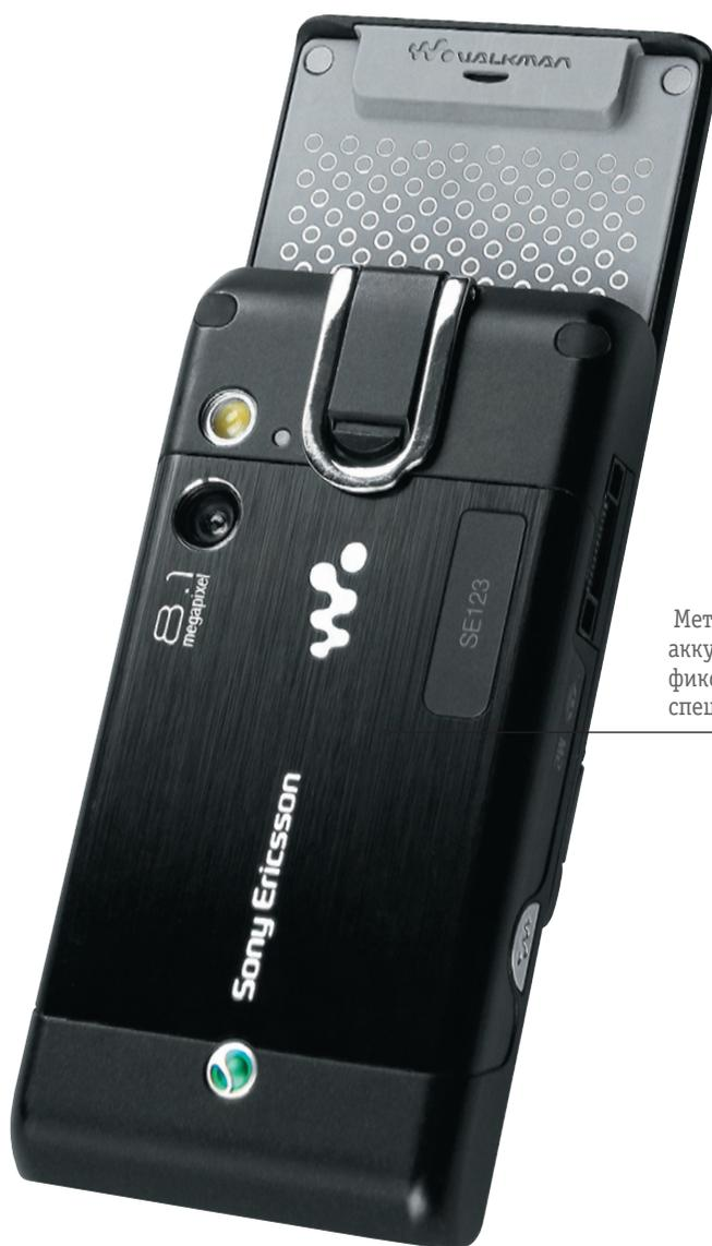
Металлическая крышка для аккумуляторного отсека фиксируется специальной защелкой
