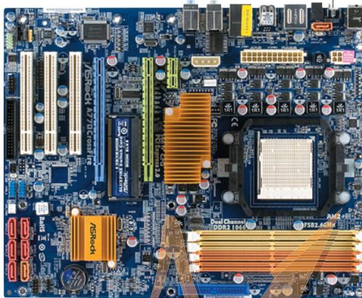
**За охлаждение мостов платы ASRock A770CrossFire отвечают небольшие радиаторы**
