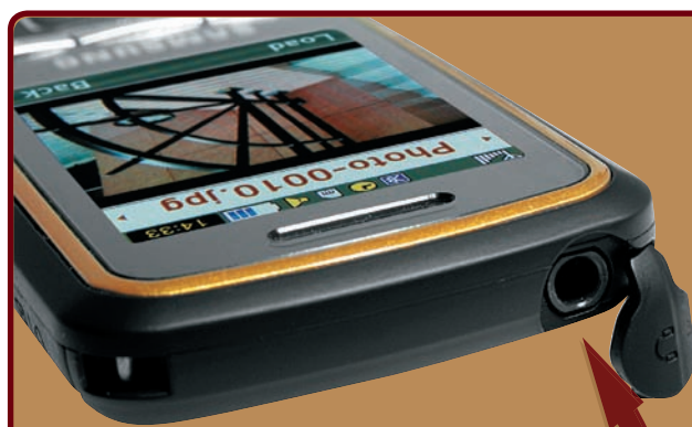
В верхнем торце находится стандартный разъем для гарнитуры, прикрытый заглушкой
