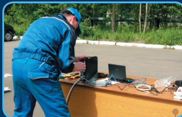
• Из коробки извлекают модем и подключают к нему кабели от антенного поста, Ethernet-кабель идет в ноутбук для настройки параметров соединения
