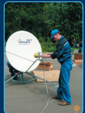
• К приемопередатчику подключается кабель: для передачи данных — белый, для электропитания — черный. Запутаться нереально
