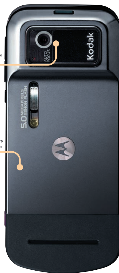
• Модуль камеры защищен активной шторкой
