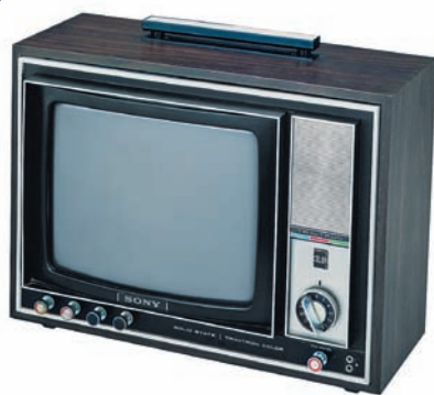
В первом цветном телевизоре Sony Trinitron вместо морально устаревшей теневой маски использовалась дешевая и простая металлическая пластина с прорезями
