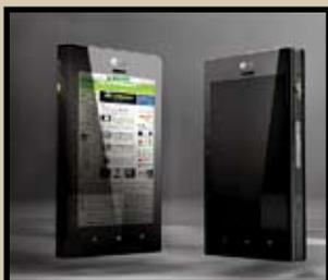
И хотя у LG уже есть аналогичный аппарат, выпускаемый под брендом PRADA, дизайнер видит свое детище более тонким и более легким. Кроме того, он оснастил торцевую поверхность LG Touch отдельным дисплеем, отображающим состояние телефона и сигнализирующем о пришедших сообщениях или воспроизводимых композициях.
