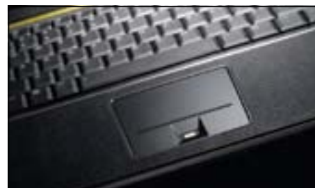
Между клавишами тачпада помещается специальное устройство для сканирования отпечатков пальцев.
