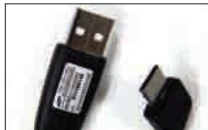
Для синхронизации с компьютером в Samsung i710 используется оригинальный кабель с нестандартным разъемом. Наушники, также приспособленные к данному стандарту, входят в комплект устройства.
