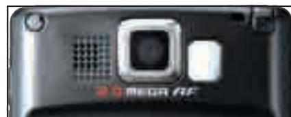
На задней панели располагается объектив камеры с зеркальным окошком для портретной съемки, а также дополнительный динамик громкой связи.
