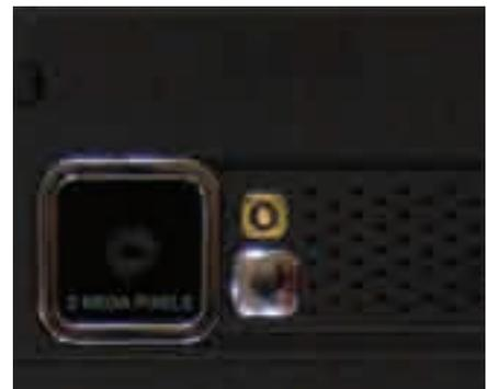
Помимо вспышки, двухмегапиксельная камера оснащена зеркальцем для съемки автопортретов и микрофоном для записи видео со звуком.
