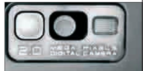
Объектив встроенной двухмегапиксельной камеры никак не утоплен в корпус и ничем не прикрыт, поэтому постоянно пачкается. Перед съёмкой его в обязательном порядке необходимо протирать.
