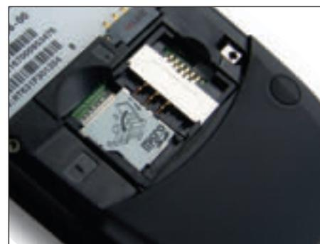
Для того чтобы придать устройству тонкие формы, создателям пришлось проявить изобретательность. Слот для подключения карт памяти микро-SD находится под SIM-картой, что предполагает очевидные неудобства для пользователя.
