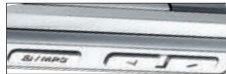
Ниже расположено прикрытое пластиковой заглушкой фирменное гнездо, в которое вставляются шнур для сопряжения с ПК и зарядное устройство, а под ним — качелька регулировки громкости и клавиша вызова аудиопроигрывателя и камеры.
