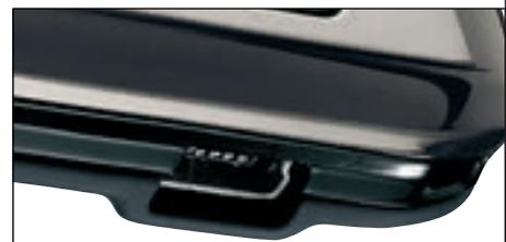
На правом торце расположен стандартный разъем мини-USB, он служит для сопряжения с ПК, подзарядки и подключения гарнитуры.
