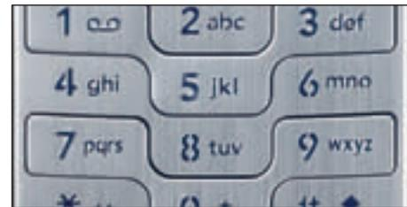
Клавиатура выполнена в виде цельной металлической пластины, над поверхностью корпуса немного выделяются лишь горизонтальные направления навигационного центра. Очень эффектно смотрится в темноте фиолетовая подсветка клавиш.
