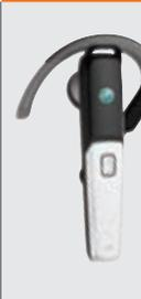
Усовершенствованная версия модели HBN-610. Основное отличие заключается в поддержке технологии Auto Pairing которая позволяет подключить гарнитуру без ввода PIN-кода. Устройство также поддерживает технологию подавления шума и уменьшения эха DSP.
