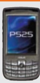
Коммуникатор под управлением операционной системы Windows Mobile 5.0 for Smartphone. Большой сенсорный дисплей поддерживает рукописный ввод, кроме того, модель оснащена функцией распознавания визиток. Кстати, камера с разрешением в 2 мегапикселя весьма качественная в своем классе. Устройство также оснащено Wi-Fi-адаптером для доступа к беспроводным сетям.
