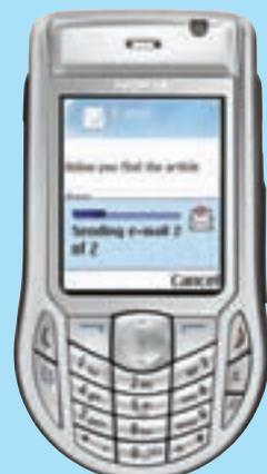
Смартфон, оснащенный 1,3-мегапиксельной камерой и работающий со сменными картами памяти формата MMC с возможностью их горячей замены.
