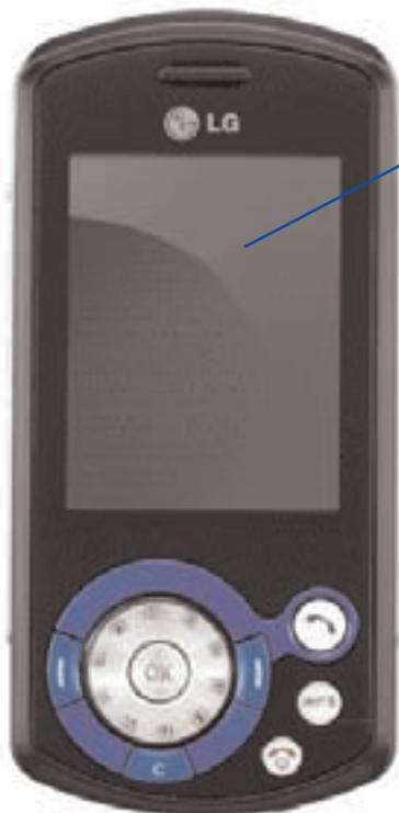
LG KE600 оснащен большим высококонтрастным QVGA-дисплеем (240x320 точек), выполненным по технологии TFT. Цветовая гамма, которую он способен отображать, стандартна для аппаратов такого класса и достигает 262 тысяч оттенков.
