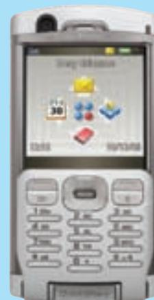
Смартфон под управлением операционной системы Symbian OS 9.1 оснащен сенсорным экраном, дополнительной клавиатурой, поддержкой Wi-Fi (802.11b) и двухмегапиксельной камерой.
