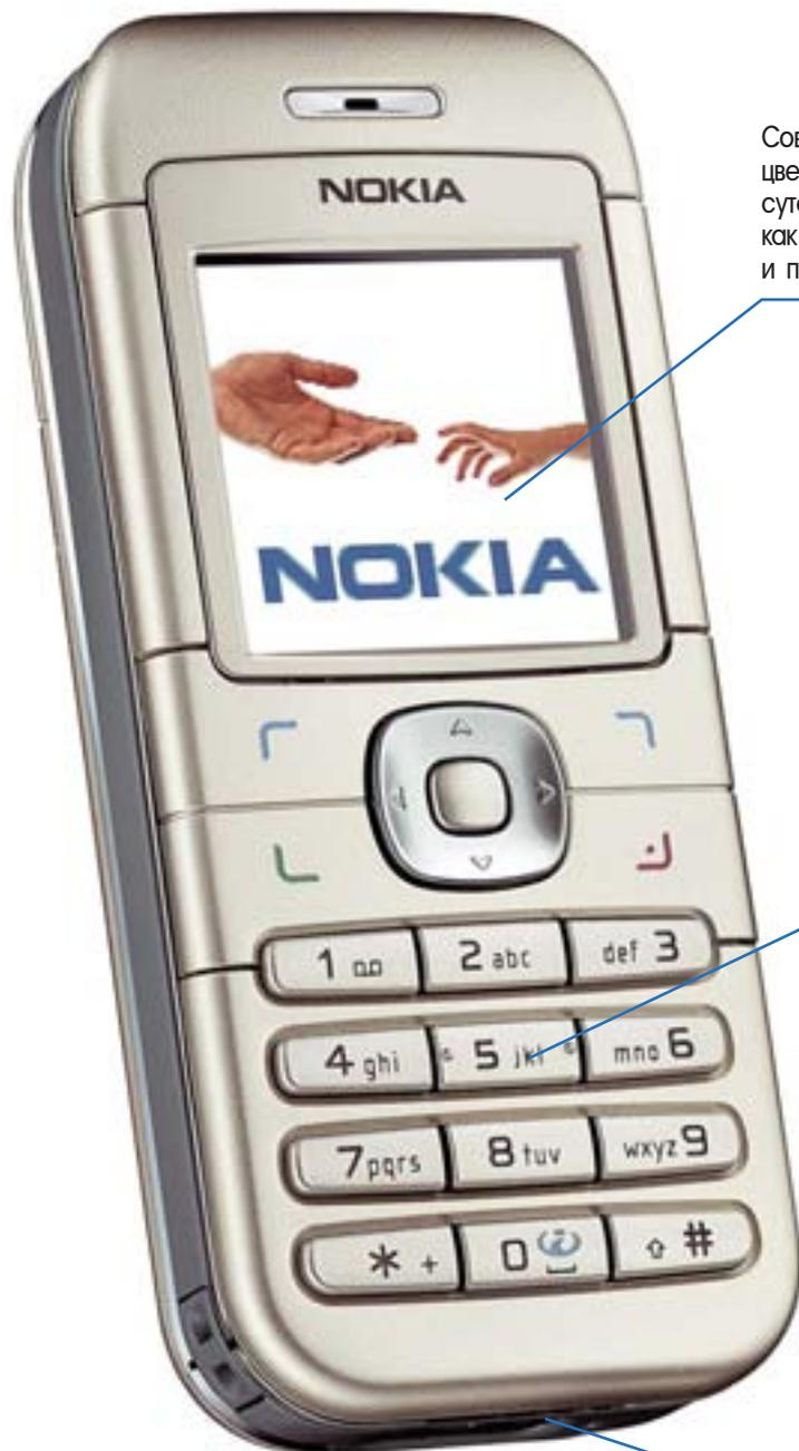
Современный ЖК-дисплей отображает палитру в 65 тысяч цветов и имеет разрешение 128x128 точек. Несмотря на отсутствие камеры (производитель позиционирует эту модель как аппарат среднего класса), есть возможность отправлять и принимать мультимедийные сообщения.
