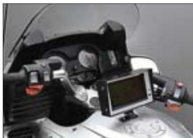
бортовых штурманов выполняют GPS-навигаторы с 3.8-дюймовым дисплеем, оснащенные, как водится, голосовыми и визуальными подсказками, предупреждающими о нужном повороте. Причем управление таким навигатором не вызовет сложностей у опытных мотоциклистов – оно выполняется с помощью устанавливаемого на руле переключателя. Мотоциклетный GPS-навигатор не входит в стандартную комплектацию и продается отдельно от байка.
