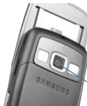
Новинка будет оснащена камерой с двухмегапиксельным сенсором. Вспышка в таком телефоне уже является неотъемлемым атрибутом. Пользователю доступна запись видеороликов со звуком, причем длина записи может достигать одного часа (!). Кроме того, аппарат поддерживает технологию прямой печати снимков без использования компьютера.
