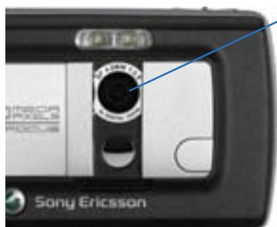
Отличительными особенностями встроенного фотоаппарата будут крышка, активирующая камеру, интерфейс цифровых фотоаппаратов Sony CyberShot, автоматическая фокусировка, режим макросъемки, фонарик и возможность видеозаписи. Вы не поверите, но эта камера позволяет делать отпечатки размером 10x15 сантиметров!
