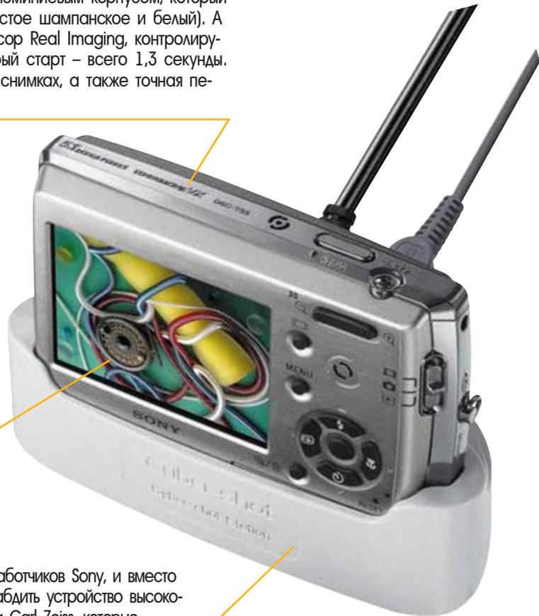
Установив Cyber-shot T33 в док-станцию, идущую в комплекте с камерой, можно подключить ее к телевизору для просмотра отснятого материала в режиме слайдшоу. Док-станция служит для передачи снимков в ПК или для зарядки аккумулятора.
