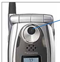
Телефон оснащен VGA-камерой со вспышкой, позволяющей делать снимки с разрешением до 640x480 точек. Есть возможность редактирования фото в самом телефоне при помощи встроенного фоторедактора.
