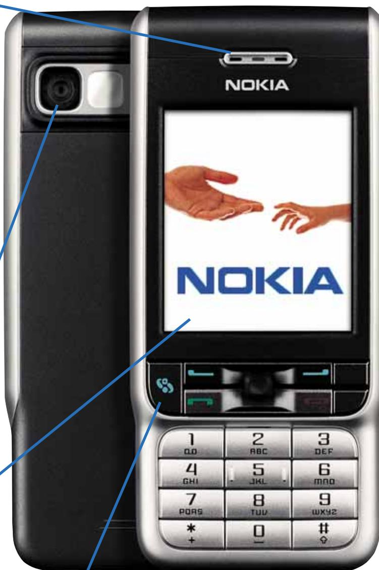
После целой серии экспериментов с расположением клавиш Nokia вернулась к классическому варианту. Удобно и функционально. Двенадцать кнопок номеронабирателя и навигационный центр, состоящий из джойстика, софт-клавиш и кнопок "принять/отклонить" звонок. Отдельной клавишей является тангета для отправки мгновенных голосовых сообщений. Жаль, что украинские покупатели этого телефона вряд ли успеют попользоваться услугой Push-to-talk – наши операторы ее еще не поддерживают.
