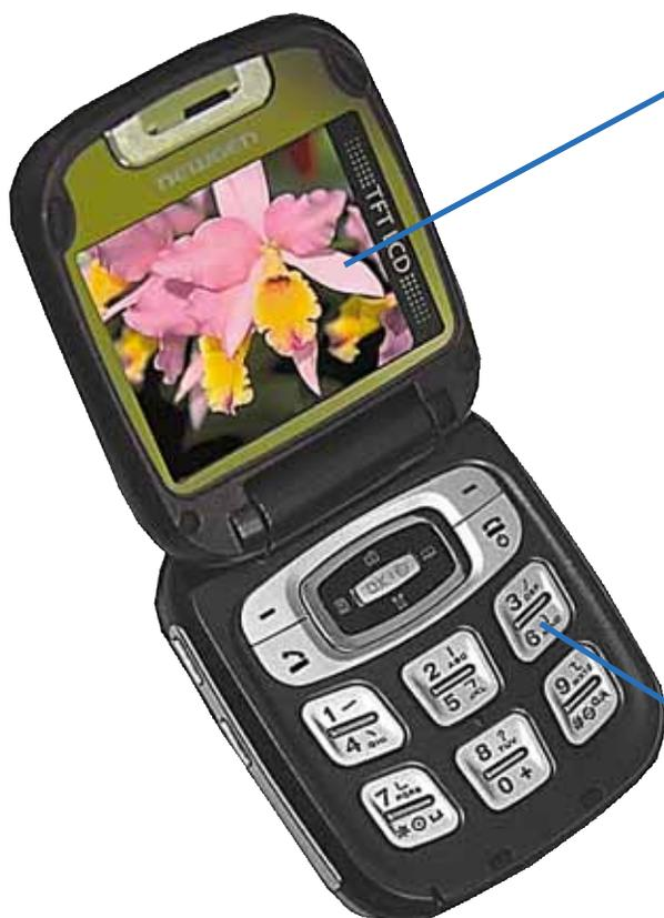
Несмотря на скромные размеры, новый телефон обладает ничуть не меньшим экраном, чем его собратья. Современный дисплей с разрешением 176x122 точки занимает большую часть внутренней поверхности верхней панели и еще больше усиливает сходство Z300 с пудреницей.
