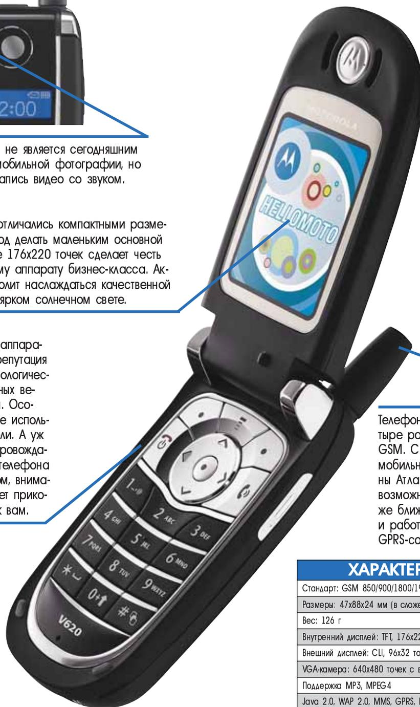
Телефон поддерживает сразу четыре разновидности стандарта GSM. С ним можно пользоваться мобильной связью по обе стороны Атлантики. Коммуникационные возможности V620 включают также ближнюю радиосвязь Bluetooth и работу в Интернете с помощью GPRS-соединения.
