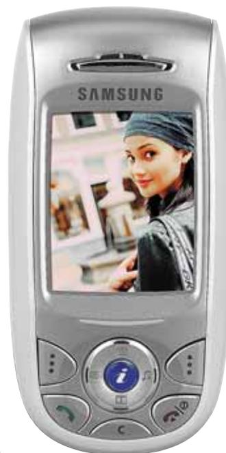
TFT-дисплей Samsung E800 очень высокого качества. Его разрешение 160x128 точек, а цветопередача – более 65 тысяч оттенков. Экрану по силам справиться с картинкой любой сложности и при любом освещении.
