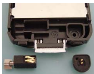
Remove Virbamotor.
